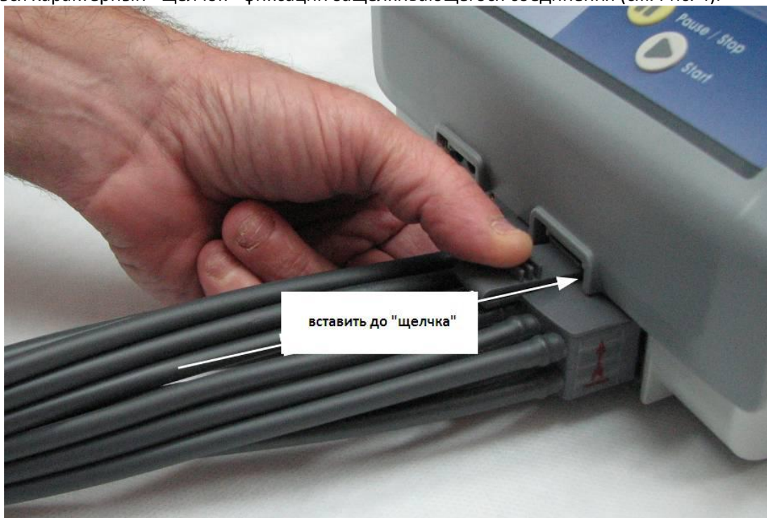
Рис. 4 – Подсоединение пучка шлангов к блоку подачи сжатого воздуха
