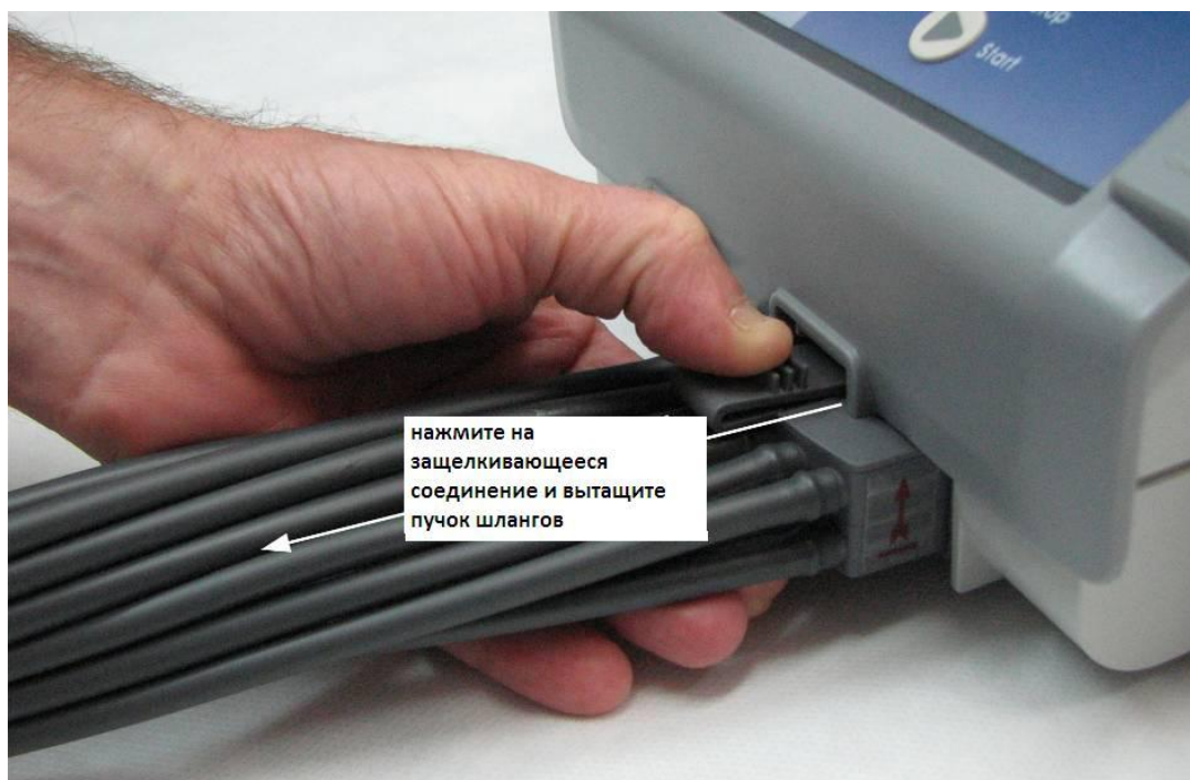
Рис. 7 – Отсоединение пучка шлангов от блока подачи сжатого воздуха
