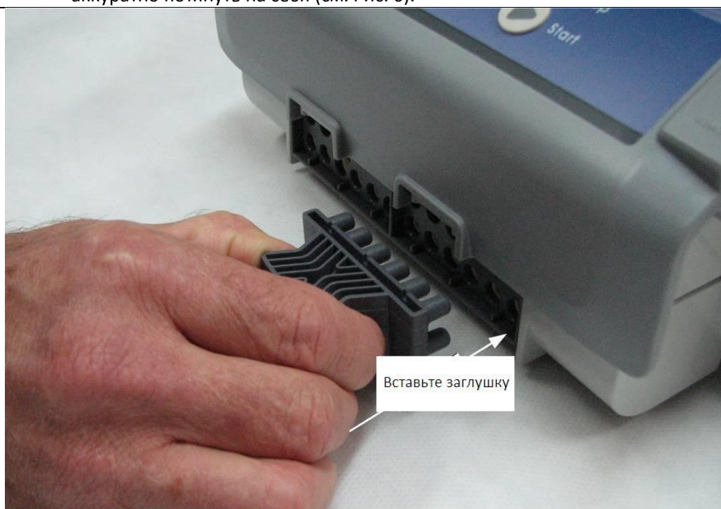
Рис. 5 – Установка 12-штыревой заглушки
